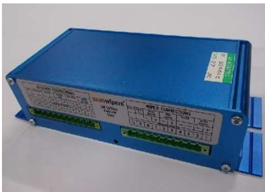
Module (MEG) pouvant commander un secteur de 10 essuie-glaces. Alimentation : 24VDC
